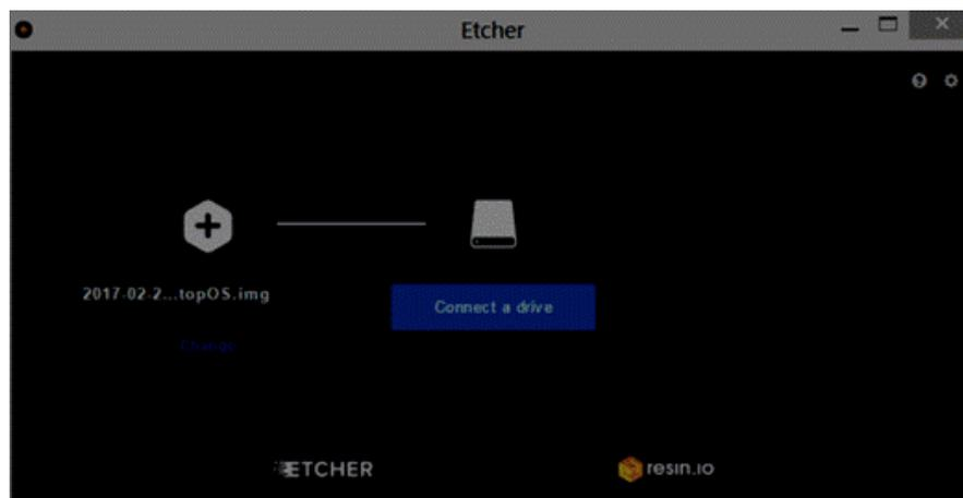
De esta forma queda instalado el sistema operativo en la tarjeta de memoria SD para ser utilizado nuevamente en el dispositivo.
