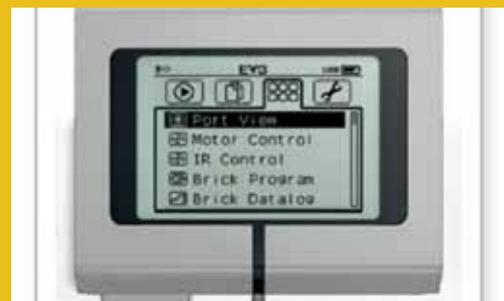
**Pantalla de aplicaciones instaladas y creación de programas:** Esta pantalla es de suma utilidad ya que permite realizar directamente, sobre el bloque inteligente EV3, programas de baja complejidad, sin tener que usar el *software* en la computadora.
